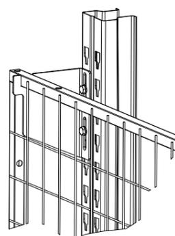
Fissaggio inferiore connettore
